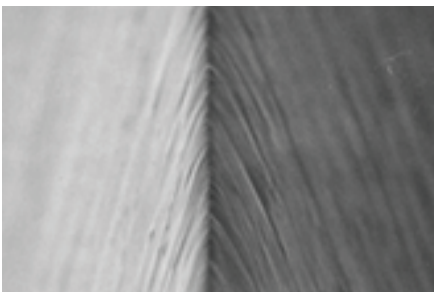
刀锋边缘的观察『扫描电镜×20,000』
